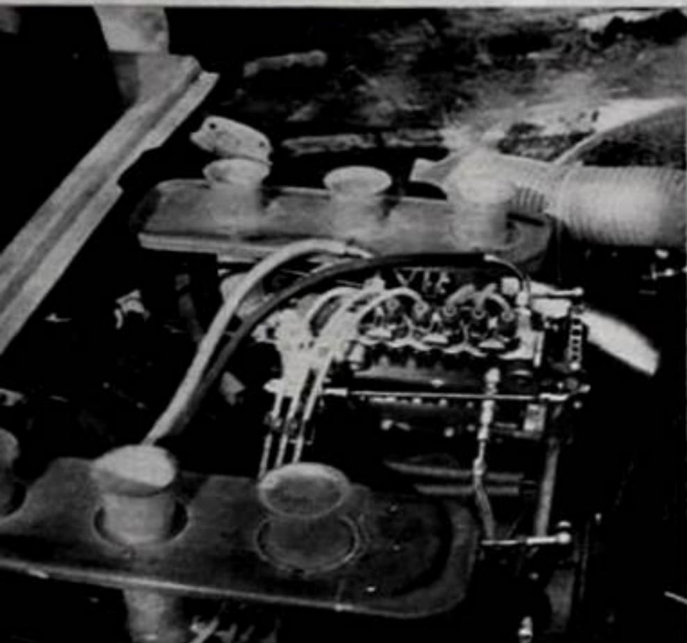
La pompa d'iniezione Bosch della Carrera 6. I condotti d'aspirazione sono in materia plastica
